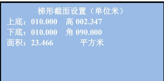
操作：数字键输入数字，‘^’，‘v’键移动游标，‘MENU’键放弃更改并退回到渠道截面选择页面，‘ENT’键确认修改参数并返回渠道截面选择页面。
